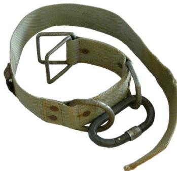
Cintura auto-costruita, di proprietà dell'Autore, con e una fettuccia in nylon da «5 cm» di larghezza e una fibbia in acciaio e due anelli a «D» in acciaio, posti frontalmente, per inserirvi un moschettone.
