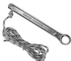
La **chiave da 13 mm** è indispensabile per serrare sia i bulloni per Roc  $\varnothing = 12$  mm coi quali si usano bulloni  $\varnothing = 8$  mm, sia i dadi per i Fix  $\varnothing = 8$  mm, poiché ambedue necessitano di una chiave esagonale da 13 mm.
