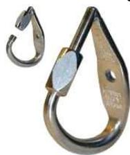
La particolare morfologia lo rende *multi-direzionale*, e l'ampia apertura (12 mm) permette il facile inserimento della gassa della corda; il diametro dell'anello ( $\varnothing = 10$  mm) non provoca la riduzione del carico di rottura della corda.
