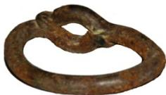
Un anello in acciaio rimasto in grotta diversi anni. Nonostante sia completamente arrugginito, si può notare il modo col quale è stato ricavato il foro in cui inserire o la vite del bullone (per i Roc) o l'estremità filettata (per i Fix).
