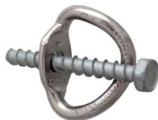
Prodotto in acciaio Inox con filo da 8 mm e foro da  $\varnothing = 8$  mm; ha una resistenza a taglio di 25 kN ed una resistenza ad estrazione di 20 kN.
