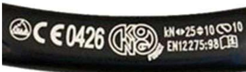
Questo moschettone è un connettore certificato «CE», identificazione del *notified body*=0426, risponde alla norma **EN 12275** (non indica la lettera, quindi si intende che è un moschettone di tipo base EN 12275/B), ha carico di rottura e di «25 kN» sull'asse maggiore e di «10 kN» sull'asse minore e di «10 kN» a leva aperta; non è certificato (EN 362) per uso lavorativo.
