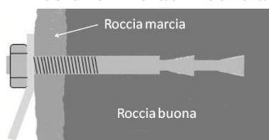
In questo caso non ha importanza se stiamo utilizzando Fix in acciaio inox a doppia espansione e se la filettatura è penetrata più di 5 mm all'interno della roccia buona.
