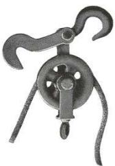
Puleggia che coll'apertura di un gancio laterale permette di mettere o togliere dalla gola una corda, pur rimanendo la puleggia attaccata per suo conto. Con essa si possono fare manovre altrimenti impossibili, per esempio distaccare in un pozzo una scala, già in tensione, da un attrito eccessivo sulle pareti, oppure inserire una corda di sicurezza troppo faticosa da far scorrere altrimenti.
