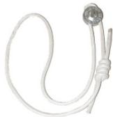
Come esempio presentiamo l'ancoraggio CTAS AXO costituito da una placchetta d'alluminio ed un anello di cordino  $\varnothing = 5,5$  mm in dyneema; la sua resistenza è di circa 18 kN ( $\approx 1\ 835$ ).
