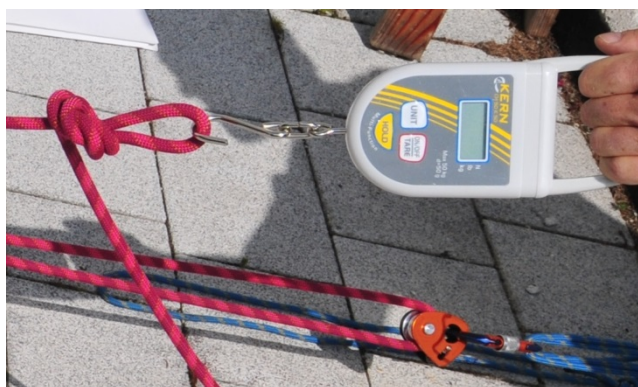
A sinistra: dinamometro per misurazione della forza di trazione; a destra: passaggio della corda per simulare il bordo crepaccio.
