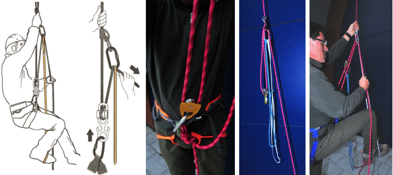
Da sinistra: schema di risalita (fonte: Kong); carrucola autobloccante ventrale, predisposizione per la risalita (con due pedali), trazione sulla corda con rinvio.
