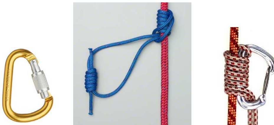
da sinistra: moschettone a pera simmetrica, nodo di Machard direzionale, nodo di Machard infilato o nodo di Bachmann (direzionale)
